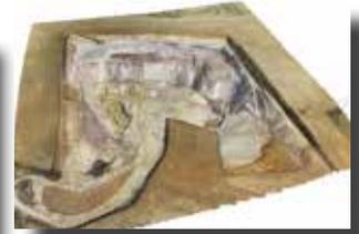
Réalisation d'un levé topographique par drone sur une carrière. Livrable d'un plan topographique, MNT, Orthophoto, Modélisation 3D de la carrière.
